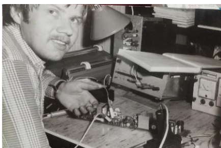
Obr. 2. Moja práca na laboratórnej vzorke nezakrytovaného semiregulovaného zdroja pre personálny počítač PP01.
