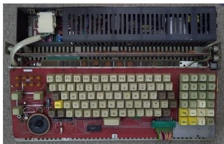
Obr. 3. Viacnapäťový semiregulovaný zdroj pre personálny počítač PP01.16
