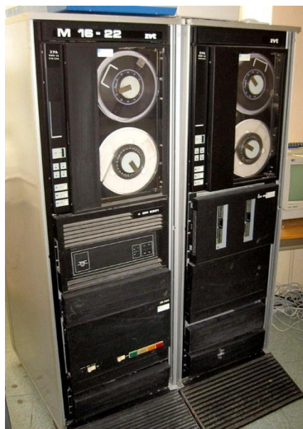
Obrázok 1. Magnetická pásková pamäť MMP45 – CM5311, prvé elektromechanické zariadenie vyvinuté vo VUVT Žilina v programe SMEP, zabudované v stojanoch SMEP, ocenené zlatou medailou na MSVB – Medzinárodnom strojárskom veľtrhu v Brne v roku 1983.
