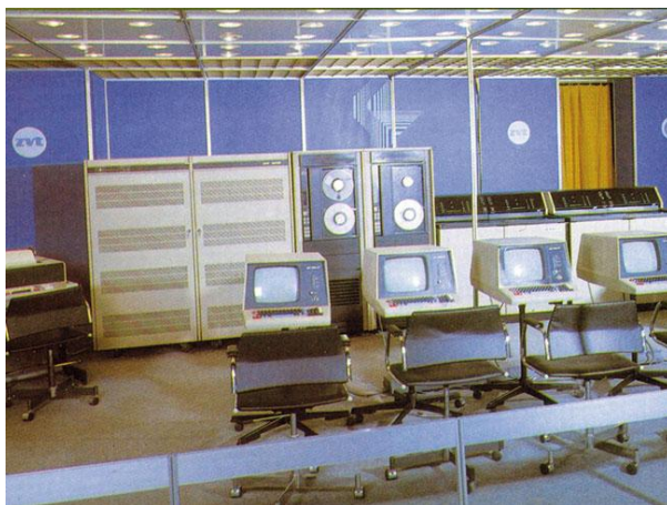
Obrázok 2. Zostava 32-bitového minipočítača SMEP SM52/12 s dvomi páskovými pamäťami MMP45 a viacerými videoterminálmi SM7202 ocenená zlatou medailou na MSVB v Brne v roku 1986.
