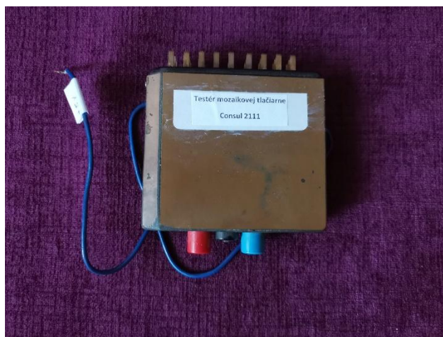
Obr. 3. Testér mechaniky mozaikovej tlačiarne Consul C2111 (z archívu SAV Bratislava)
